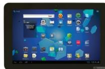
Представляет из себя мобильное устройство, работающее под управлением операционной системы Android. Пульт сохраняет всю историю действий судьи и передаёт её на сервер системы по беспроводному каналу WiFi. При возникновении спорных ситуаций это даёт возможность оценить корректность работы судьи.
